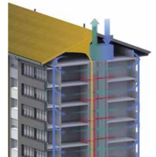
1. Le schéma général de l'intervention qui a permis d'atteindre une réduction de la consommation de plus de 80%. 2. Les objectifs des concepteurs ont été bien définis: amélioration de l'efficacité énergétique de l'enveloppe du bâtiment, nouveau concept de production de chaleur, création de réseaux de ventilation avec une récupération de chaleur sur l'air extrait, comptage de la consommation énergétique et mise en place d'un processus de mise en œuvre en site habité faisant largement appel à la préfabrication.
