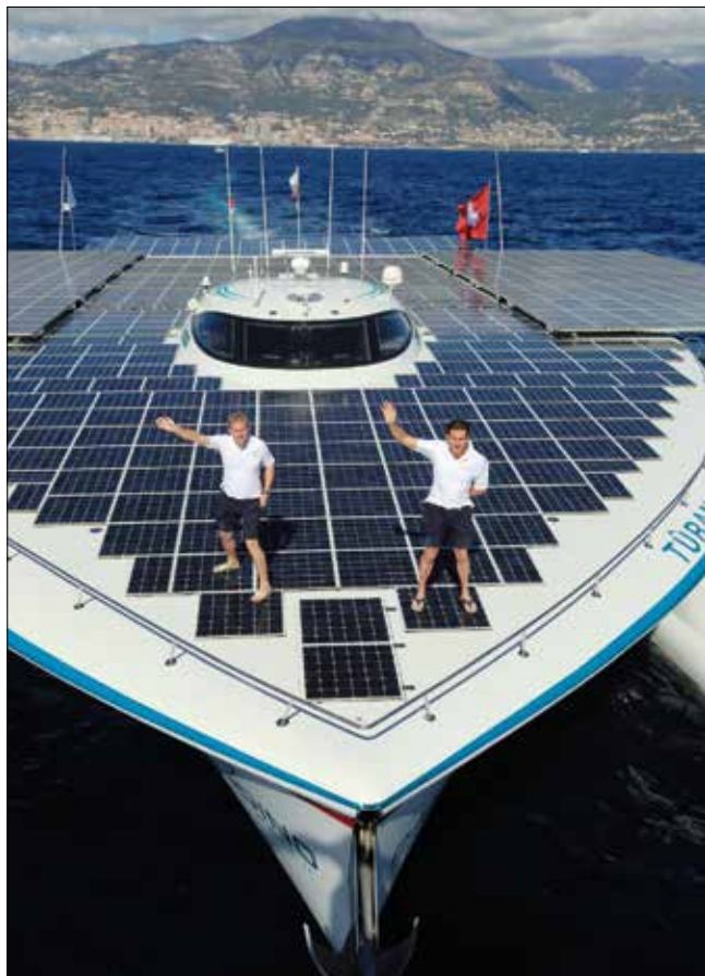
La catégorie «Personnalités et institutions» a récompensé le bateau MS Tûranor PlanetSolar pour ses performances énergétiques solaires. Ses 537 m 2 d'installations, d'une puissance de 93,5 kWc, produisent 167 900 kWh/an.
